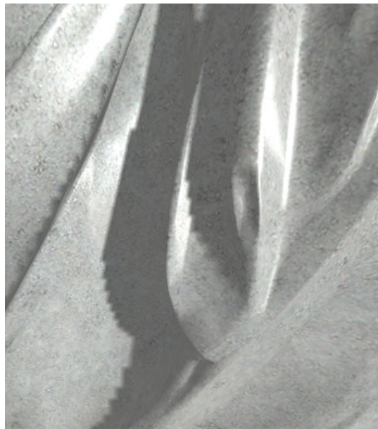
Rysunek 4.51: Błędy spowodowane małą rozdzielczością i niedokładnością mapy cienia.
