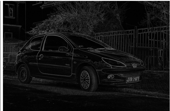
(d) Obraz po nałożeniu złożenia pionowego i poziomego operatora Sobela
