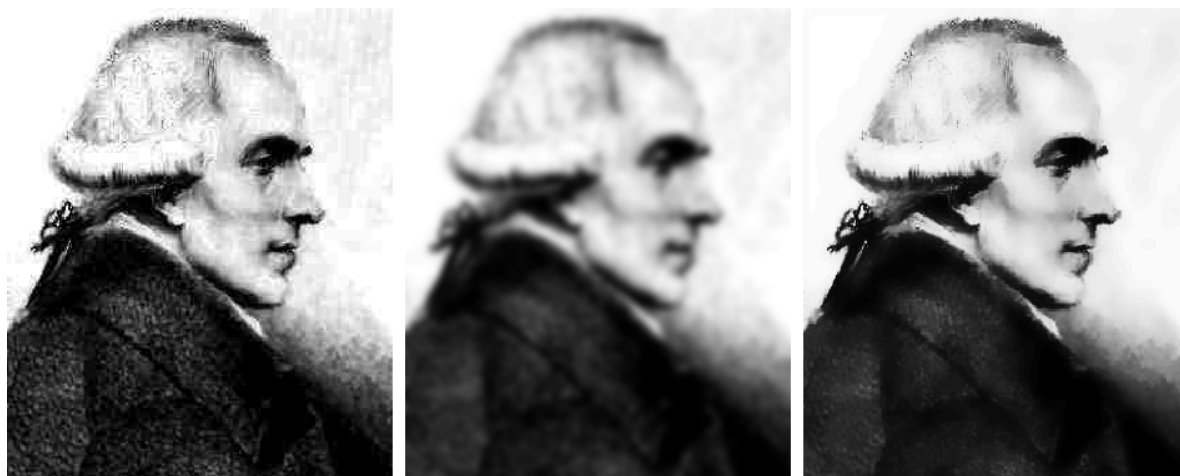
Rysunek 2.24: Działanie filtra bilateralnego na zwykły obraz. Z lewej oryginalny obraz, w środku obraz rozmyty zwykłym filtrem gausowskim, z prawej obraz przefiltrowany bilateralnie. Lewy i prawy obrazek zapożyczony z pracy [4].
