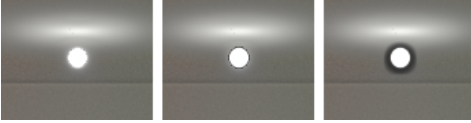
Rysunek 2.21: Zjawisko halo (odwrotne gradienty) wokół źródeł światła. Z lewej poprawny obraz, w środku lekkie halo, z prawej mocne halo. Oryginalny obrazek to cornellbox.hdr pobrany ze strony E. Reinharda ( http://www.cs.utah.edu/~reinhard/cdrom/hdr/ )
