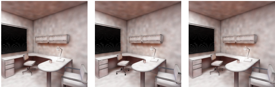
Rysunek 6.15.: Irradiancja wyznaczona na podstawie mapy fotonów (po lewej), oszacowań z odchyleniem do 5^\circ (w środku) i 20^\circ (po prawej).
